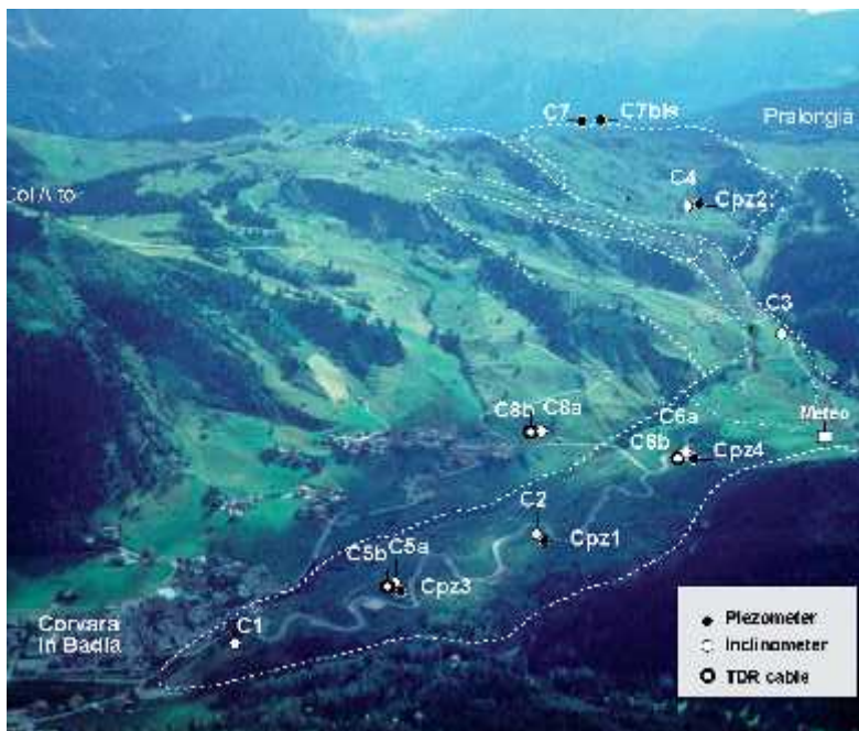
Fig. 5.25 - La frana di Corvara in Badia, con l'ubicazione dei principali strumenti di misura geotecnici. Foto di Alessandro Corsini
